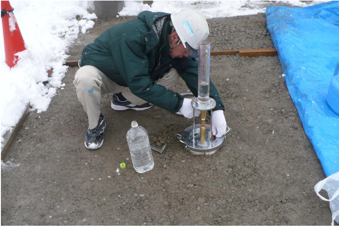
R C 40ATTAC (路盤工法) 50mm減少時間 平均 8 秒 透水係数 1.02E-04
